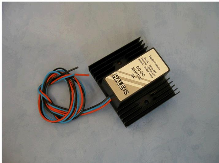
DC-DC pulsní měnič stejnosměrného napětí je určen pro napájení autorádií, radiostanic nebo jiných spotřebičů s napájením 12V max 3A. Měnič se připojuje na palubní síť vozu 24V a je chráněn proti krátkodobým přepětím v palubní síti. Měnič poskytuje maximální výstupní výkon 40W.
